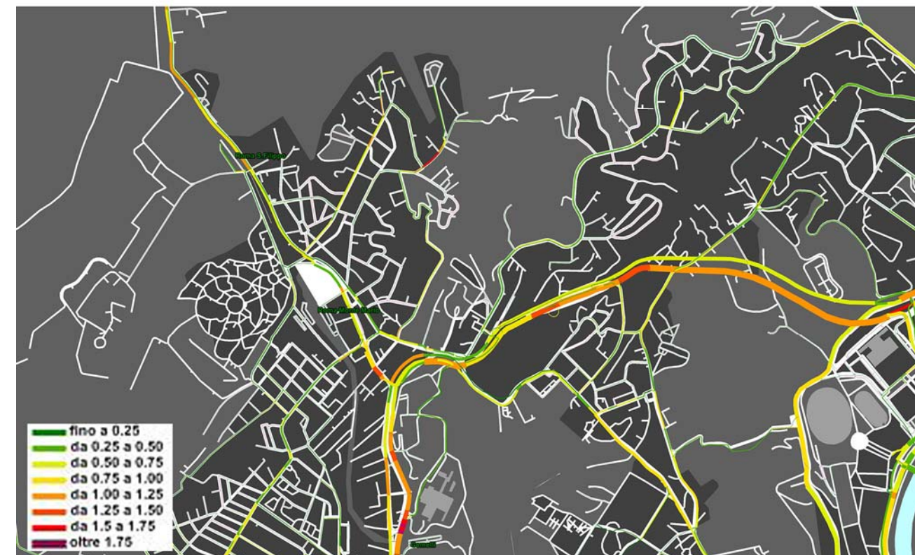
FIGURA 2-2 FLUSSI EQUIVALENTI DI TRAFFICO, IN ALTO, E RAPPORTO FLUSSO/CAPACITÀ, IN BASSO, NEL SETTORE NORDOVEST DI ROMA ALL'INTERNO DEL GRANDE RACCORDO ANULARE (ROMA SERVIZI PER LA MOBILITÀ)
